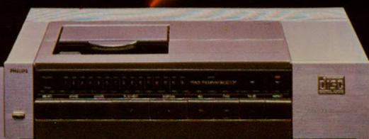
1. **Un reproductor de Compact Disc**, de apariencia similar a los componentes conocidos de alta fidelidad, pero con tecnología completamente distinta, reproduce un pequeño disco metálico de 12 cm. de diámetro, que admite hasta una hora de música, en una sola cara.
