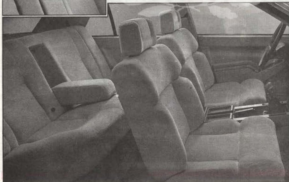
El diseño de los asientos delanteros con apoyacabeza adaptado, totalmente nuevo, es el fruto de los últimos estudios de Renault en materia de ergonomía. La regulación longitudinal y de la inclinación del respaldo se realizan manualmente. Los apoyacodos laterales en la parte delantera son realmente tapaderas de guanteras. Los asientos traseros están equipados con reposacabezas integrados, en las versiones GTX y Turbo D. Tapicería integral en tejido mate.
