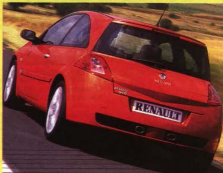
Fuente de altas prestaciones, el motor 2.0 Turbo 16 V de Mégane Renault Sport desarrolla una potencia de 225 cv a 5.500 r.p.m. y alcanza un par de 300 Nm a 3.000 r.p.m. Fuertes aceleraciones y rápidas subidas de régimen, Mégane Renault Sport va de 0 a 100 km/h en 6,5 segundos. Su generoso par, disponible al 90% entre 2.000 y 6.000 r.p.m. responde con agilidad a todas las peticiones del conductor.
