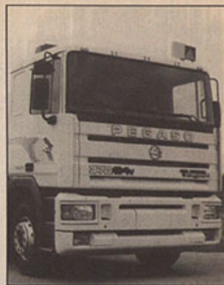
La tractora TRONER 370 6x4 extra-pesada, con una capacidad de arrastre total de 70 de toneladas, de sólida mecánica y gran confort de conducción.
