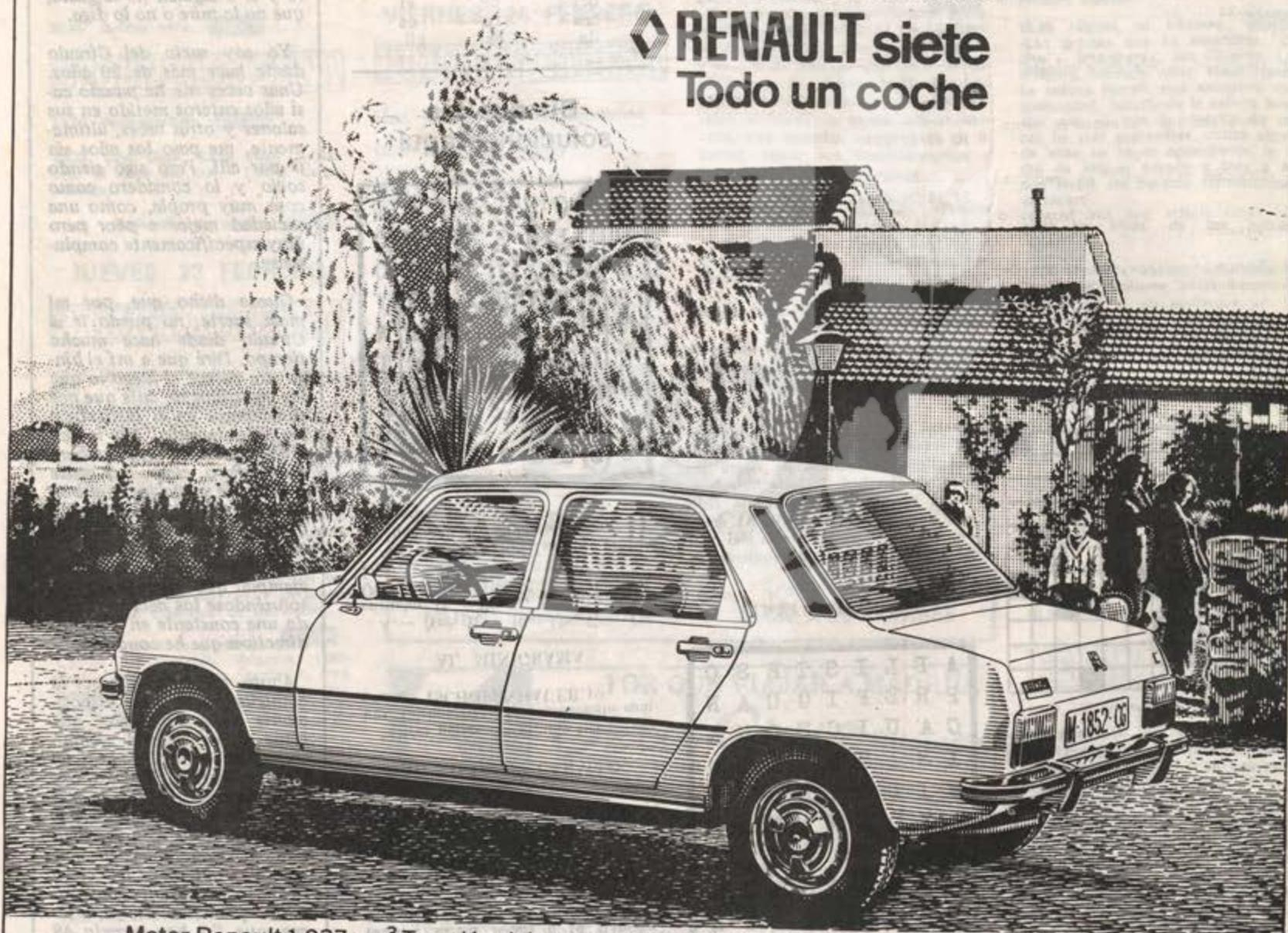
Motor Renault 1.037 cm<sup>3</sup> Tracción delantera. Suspensión por barras de torsión. Cuatro puertas.
