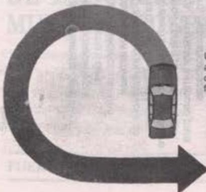
Un radio de giro (5,15 m entre aceras) que permite una conducción y un aparcamiento fáciles.
