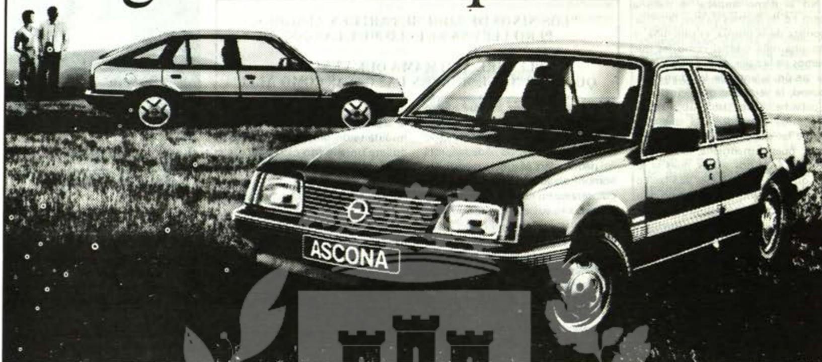
Motor de 1.6 l. 90 CV, tracción delantera, suspensión McPherson. Encendido electrónico. 6 litros a 90 km/h. 170 km/h. velocidad máxima.
