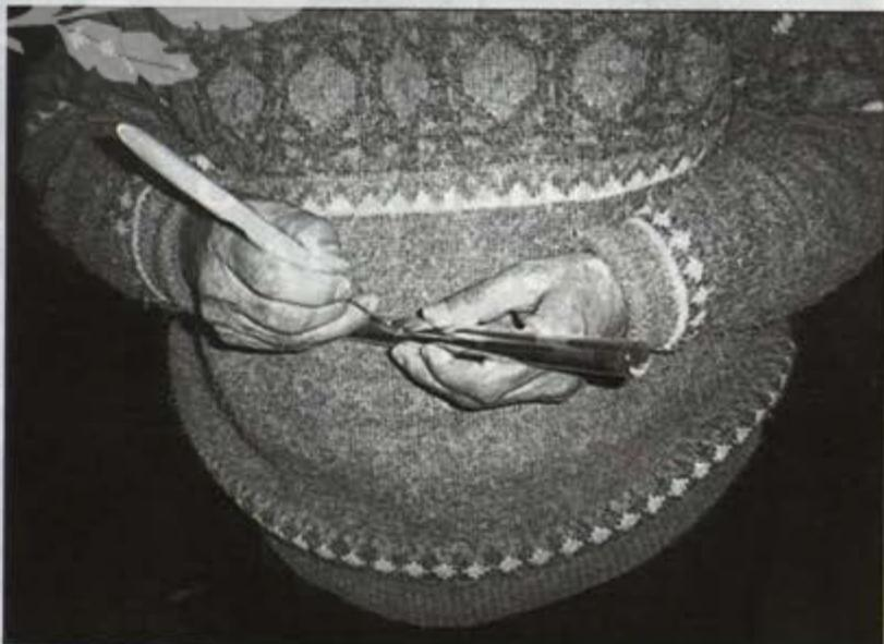
Proceso de afinado: A la izquierda, apertura del tubo con el cuerno de afinación para los graves. A la derecha, corte de la boca del tubo para los agudos.
