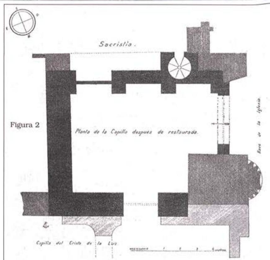
Figura 1.- Medidas: 6,20 NS y 7 EO en metros. Escalera provisional para subir al órgano que daba a la nave lateral de la parroquia. Procedía de San Diego. La ventana de abajo estaba tabicada. Se entraba desde la sacristía. Figura 2.- Estado de planta tras las obras de Cabello Lapidra
