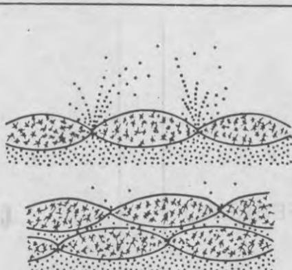
Secciones de saco simple y doble. El calor y sus escapes al exterior se han representado con puntos.
