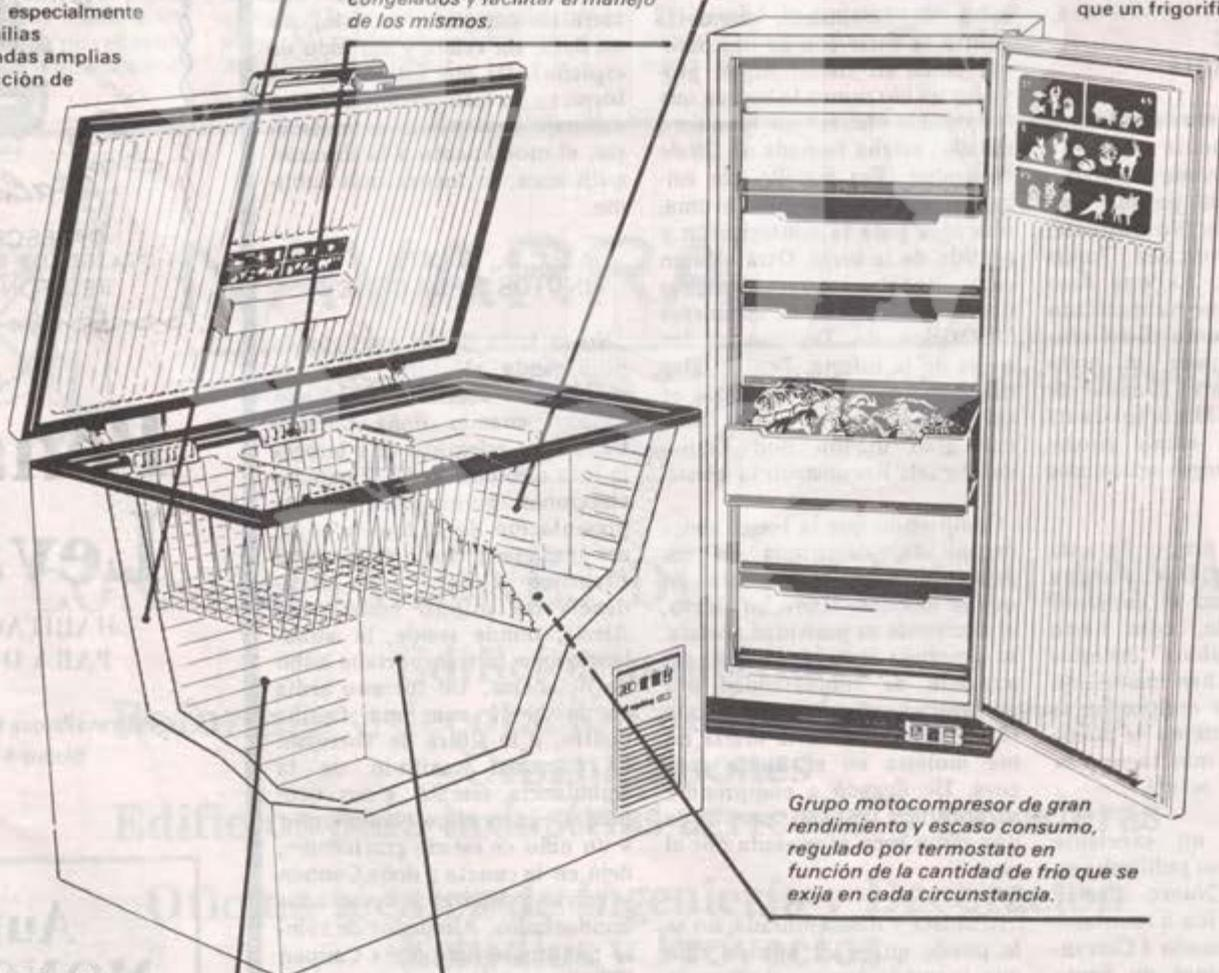
*Circuito "Roll-Bond" impreso en la pared del congelador, sistema ideal para transmitir el ultrafrío ZANUSSI rápidamente a todos los alimentos almacenados en el congelador.*
