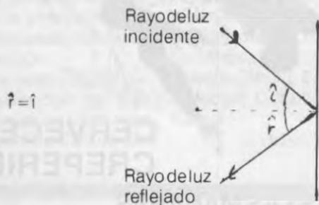
Fig. 1: Igualdad de los ángulos de incidencia y reflexión de la luz
