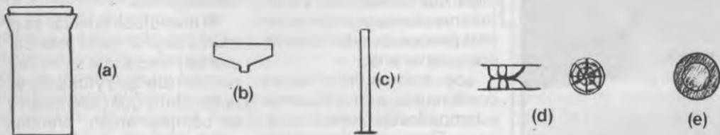
Fig. 1: Partes integrantes de un tanque de revelado. a) Compartimento estanco, b) Tapa, c) Eje de sujeción de las espirales, d) Espirales de revelado, e) Sobretapa
