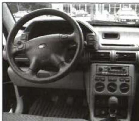
Esta caja de cambio automática, de serie en el V6, dispone de varios modos de conducción para una mayor satisfacción y control del conductor. En el modo "normal" se maneja una caja de cambios automática convencional, pero si movemos la palanca a la posición Steptronic, se adopta el modo "deportivo", posición en la que la caja baja de velocidad rápidamente y mantiene las velocidades inferiores por más tiempo, consiguiendo así mayor aceleración y mejor respuesta.
