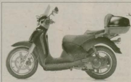
La máquina pesa 169 kg y cuenta con un amplio hueco de almacenamiento bajo el asiento de 34 litros de capacidad, que se abre con mando y baúl opcional de 47 litros más bolsa de 50. Entre sus accesorios, lleva un sistema antirrobo en el equipamiento de serie.
