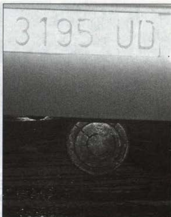
El bolardo acometió al autobús por los bajos, le causó averías y, a su vez, sucumbió bajo el peso del vehículo.
