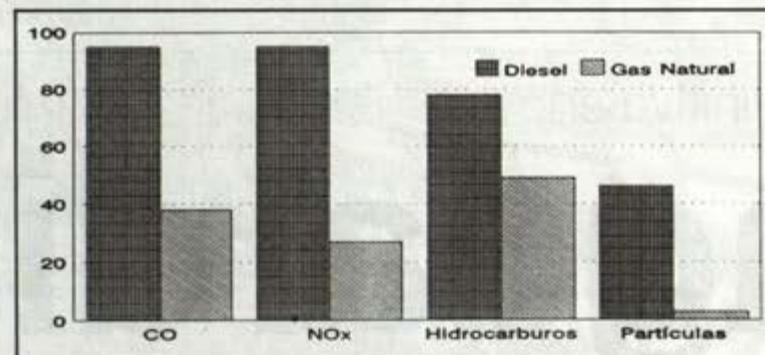
En este gráfico, y en una escala de 0 a 100, puede observarse que la emisión de monóxido de carbono y óxidos de nitrógeno se reduciría a menos de la mitad en el caso de que el carburante fuese gas natural en lugar de diesel.
