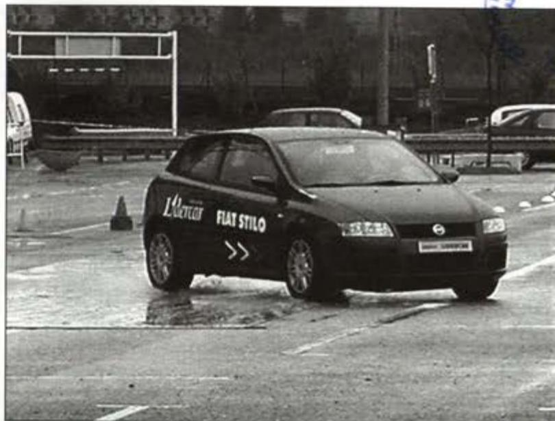
Entre las pruebas realizadas al Fiat Stilo destacaron las frenadas en suelo mojado, el slalon o el control de derrapaje.
